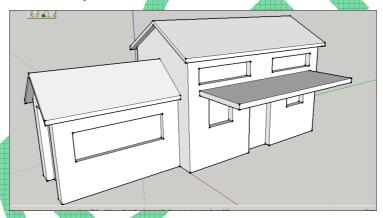
Seleccionar la herramienta mover, y haciendo clic sobre la arista superior del frente de la marquesina, desplazar el cursor hacia abajo, (siguiendo el eje azul pulsando la flecha de dirección hacia abajo al mismo tiempo) hasta que las dos aristas casi se junten.
