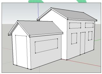
Con la herramienta empujar/tirar, introducir ligeramente los rectángulos de las ventanas y puertas hacia el interior de la casa (Realízalo en una ventana y repite la operación con doble clic en el resto de puertas y ventanas).
