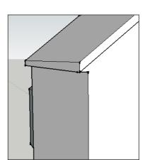
Retocar las uniones de las paredes exteriores con el alerón, trazando una línea vertical desde las esquinas de los rectángulos hasta el alerón y, con la herramienta empujar/tirar, eliminar el volumen sobrante, empujando la superficie triangular hasta el final de la pared. Eliminar las líneas sobrantes sobre las paredes exteriores.
