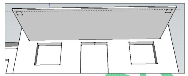
Con la herramienta Empujar/tirar empujar hacia abajo cualquiera de los dos cuadrados dibujados. Para ajustar la altura de los pilares, lo empujaremos hasta hacer coincidir el cursor con una arista inferior de la casa.
